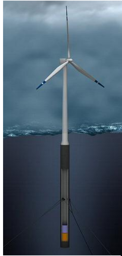
Figura 4.9: piattaforma Ballast Stabilized.
