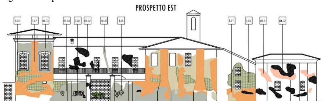
Figura 160: rilievo del degrado
