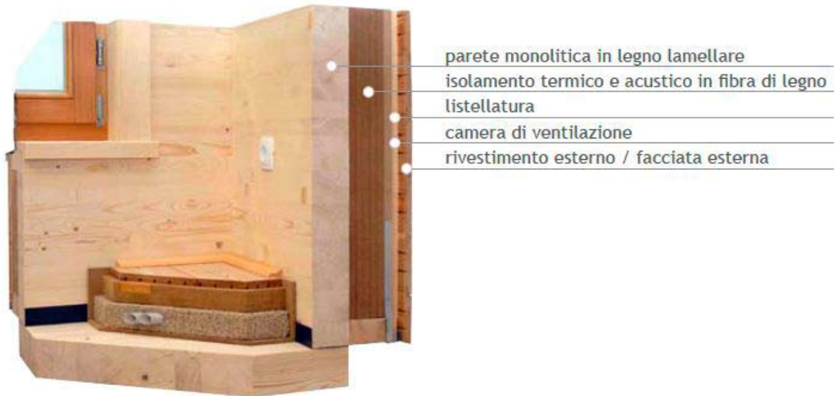
fig. 59 stratigrafia di una parete monolitica tipo delle case Riko
