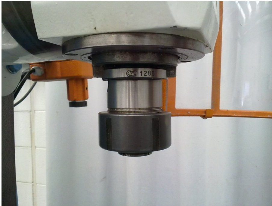
Figura 5.3 Mandrino della fresatrice Matesina F.U.1s
