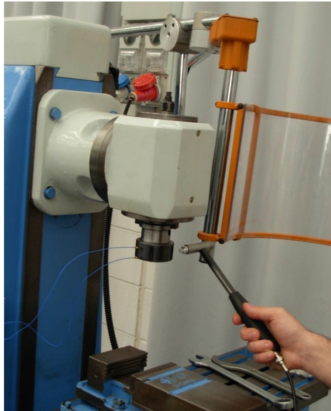
Figura 6.13 Misurazione delle FRFs tramite impact-test
