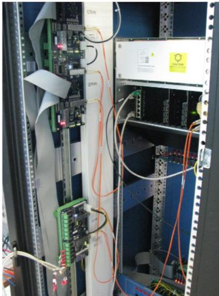
Figura 5.4.3 Connessione ottica delle schede (cavo di colore arancione)
