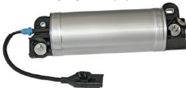
Figura 2.13 Active Boost prodotto da Continental AG per la seconda generazione di veicoli start&stop del gruppo PSA Peugeot e Citroen.
