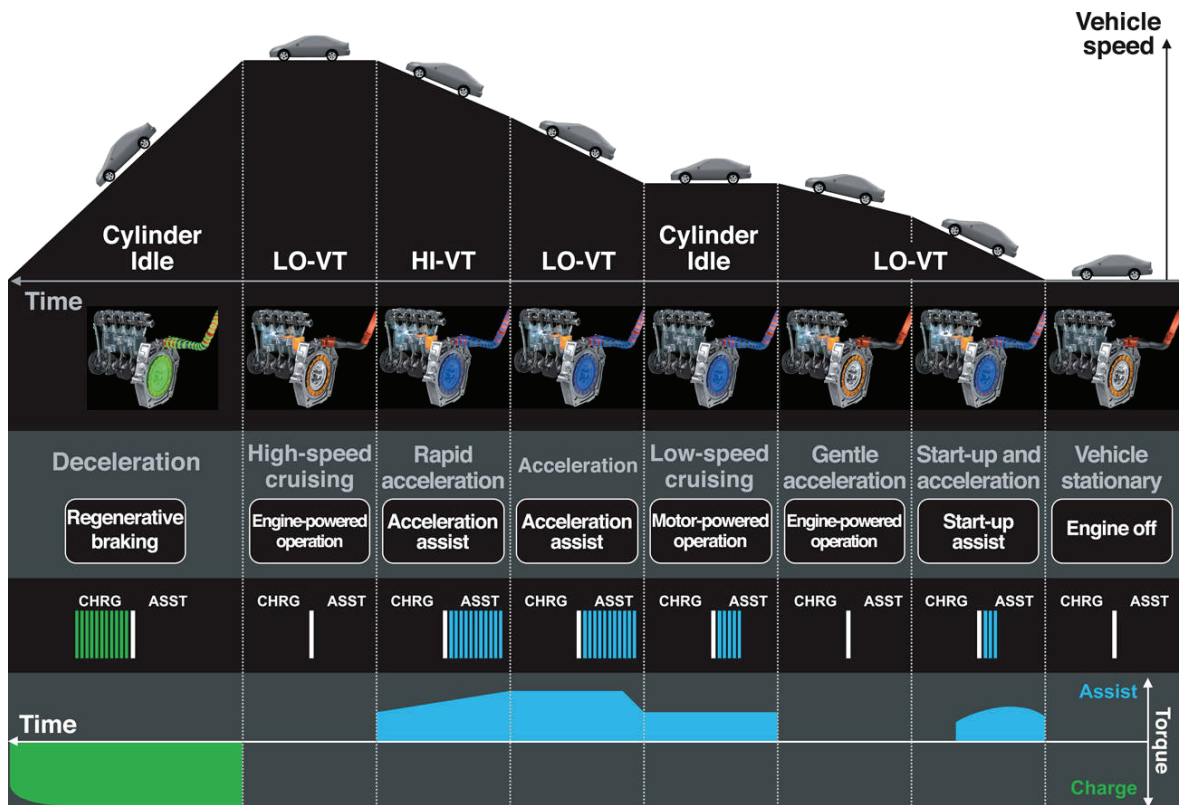
Figura 4.6 Funzionamento del sistema IMA della Honda
