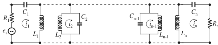
Fig. 3.1 Circuito equivalente di n risonatori accoppiati attraverso mutue induttanze
