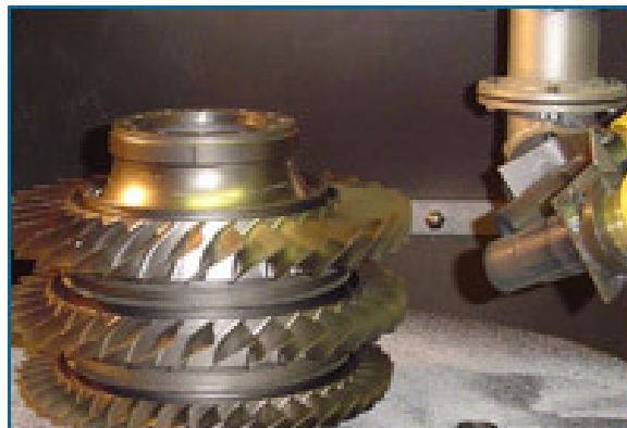
Figura 1.3-Air peening machine, esempio di peening su una girante
