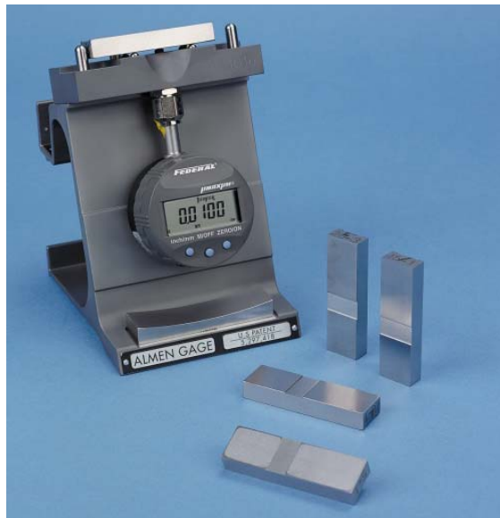
Figura 1.2-Almen test strip e Almen gage
