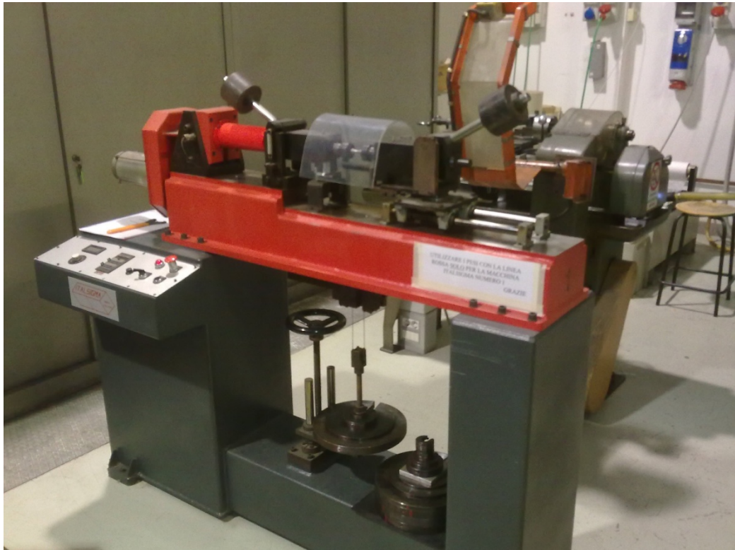
Figura 4.11-Test a flessione rotante con macchina Italsigma
