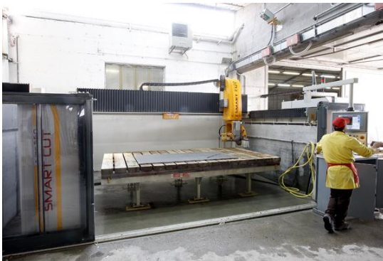
Figura 266 - Il taglio delle lastre
