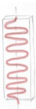
Figura 248 - Tubolare annegato in pietra ricomposta
