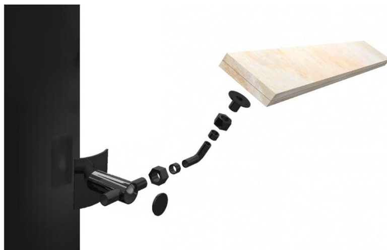
Figura 279 - Esploso del sistema di fissaggio della lamella
