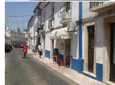
Una delle vie del centro storico di Vila Viçosa. Caratteristici gli intonaci bianchi, le tinteggiature blu, rosse e gialle, le zoccolature in marmo, la pavimentazione in pietra, le soglie delle porte, gli architravi e gli stipiti in marmo.
