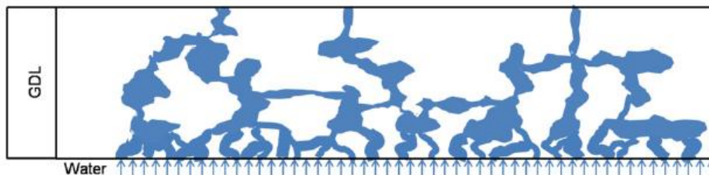
Figura 4.3 Percorsi preferenziali seguiti dall'acqua in un GDL single layer [7]
