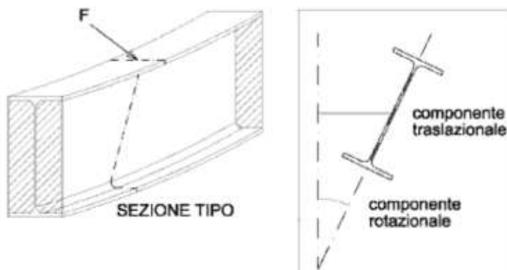
Fig.11.43 Profilo soggetto ad instabilità flesso-torsionale
