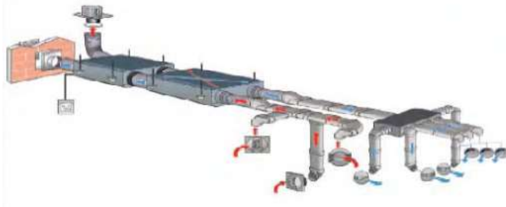
Fig.9.43 Schema di funzionamento di VMC a doppio flusso con recuperatore di calore
