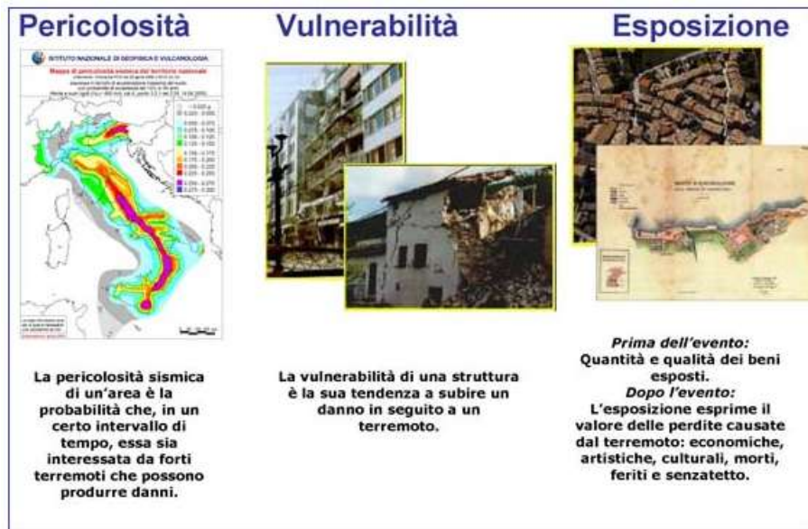
Fig.11.5 Quadro schematico delle tre componenti che determinano il rischio sismico
