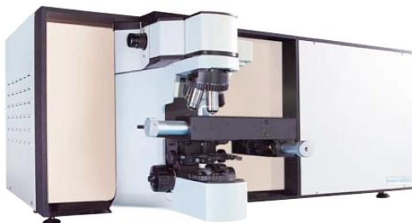
Figura 1.7. Raman dispersivo LabRAM HR800 in modalità micro con microscopio Olympus BX41 e stage per mapping.[www.horiba.com]
