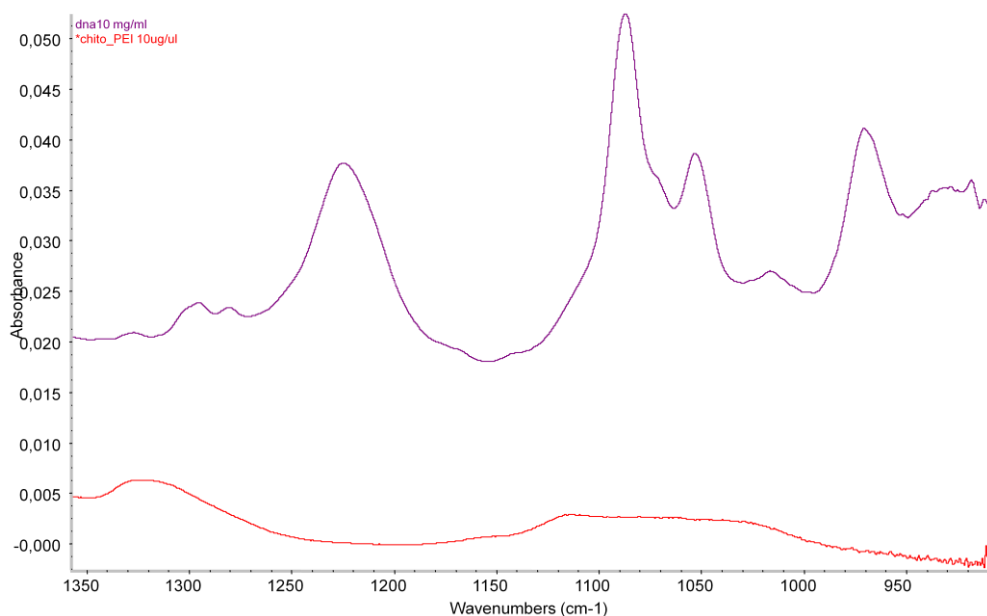
Figura 5.22. Confronto tra lo spettro di ssDNA 10 mg/ml (viola) e di chitosano-g-PEI 10 mg/ml (rosso). Spettri registrati a parità di cella e riportati in common scale .
