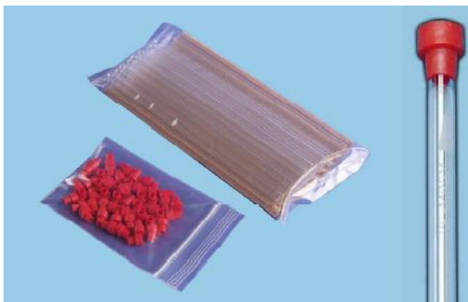
Figura 4.11. Tubi NMR nella confezione da 50 pezzi separati dai tappi (a sinistra) e immagine dell'oggetto assemblato (a destra). I tubi NMR utilizzati hanno diametro nominale di 5 mm, spessore della parete in vetro di borosilicato di 0.4 mm e lunghezza di 178 mm. [www.spectra2000.it]
