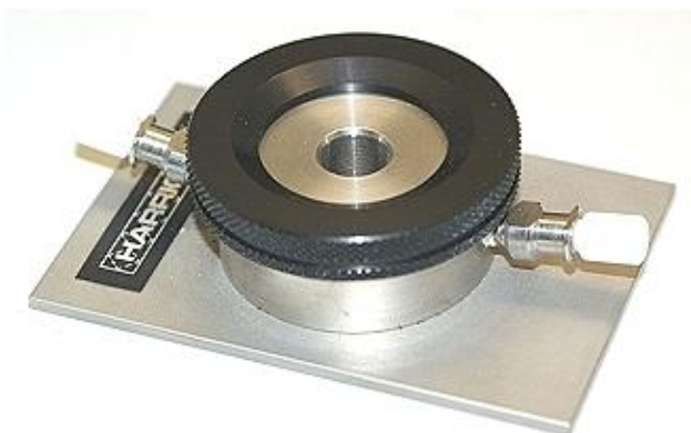
Figura 2.11. Supporto in cui sono inserite le finestre di \text{CaF}_2 tra cui è interposto il campione in soluzione. [www.harricksci.com]
