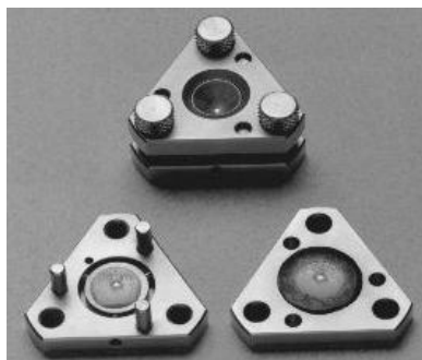
Figura 5.16. Immagine di una cella di diamante a pressione chiusa (in alto) e aperta (in basso). [www.hpdo.com]
