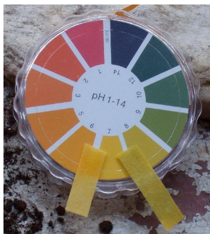
Figura 5.7. Indicatore a cartina tornasole di tipo universale, cioè sull'intero intervallo di variazione di pH (1-14). [www.chimicare.org]
