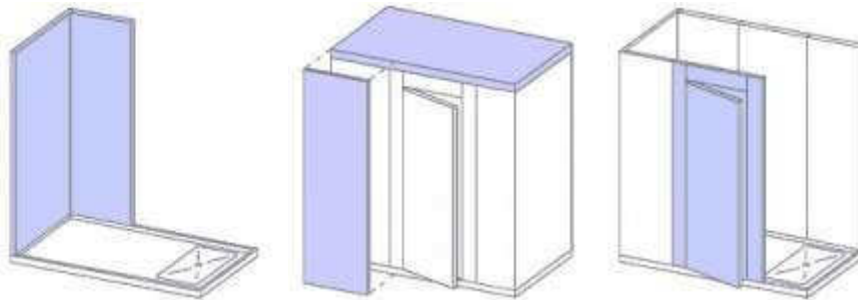
[Fig.7.2.3.1] Esempio di montaggio del bagno prefabbricato
