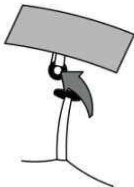
[Fig.8.3.3.6] Sistema di attacco della parete divisoria
