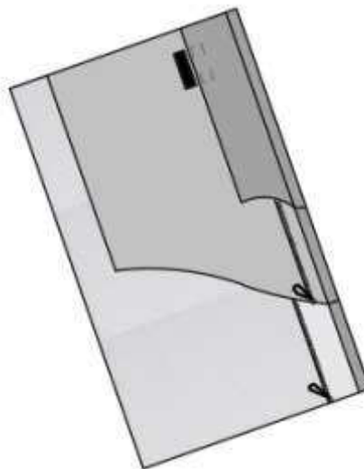
[Fig.8.3.4.1] Sistema di impermeabilizzazione delle cerniere
