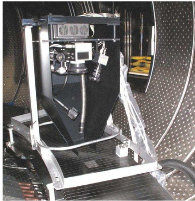
Figura 3.2: Prototipo del sistema remotizzato LASK (Laser Ablation System Kit) nel tokamak Tore Supra. [117]
