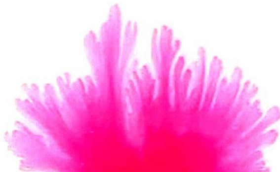
Figura 1: Viscous fingering dovuto all'iniezione di cherosene in olio minerale [9]
