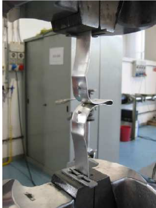
Figura 2.2: Macchina utilizzata per la trazione dei provini.
