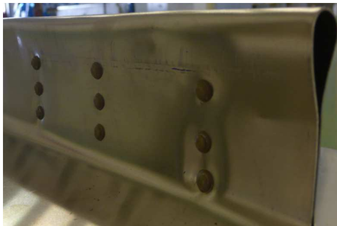
Figura 3.5: Dettaglio dei rivetti su una flangia del pannello.
