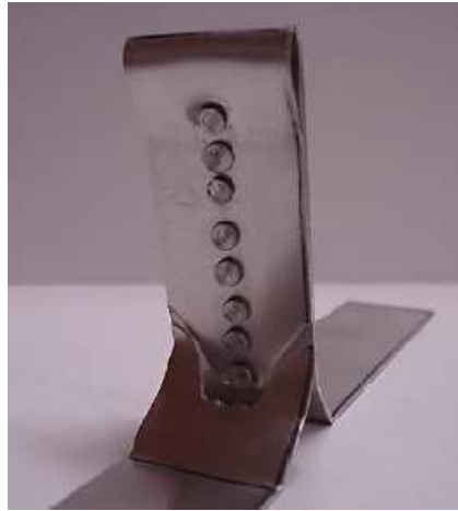
Figura 2.3: Rottura non desiderata della lamiera in seguito al ridotto passo tra i rivetti.
