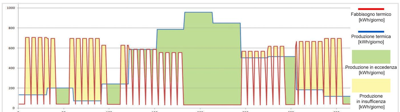
Fig. X-51 Fabbisogno quotidiano degli utenti e produzione di energia termica in proveniente dai pannelli solari. [kWh/giorno].
