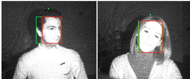
Figura 4.12: Nelle due immagini riportate, è riportato in verde il ROI ottenuto con l'algoritmo di head detection ed in rosso quello ottenuto con la seconda fase di analisi (face detection).
