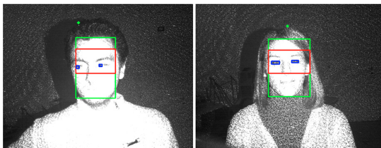
Figura 4.17: Risultati dell'algoritmo di eyes detection.
