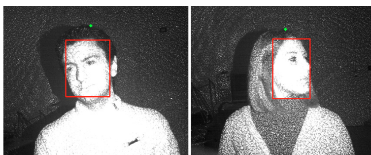
Figura 4.13: Risultati dell'algoritmo di face detection in condizioni particolari.
