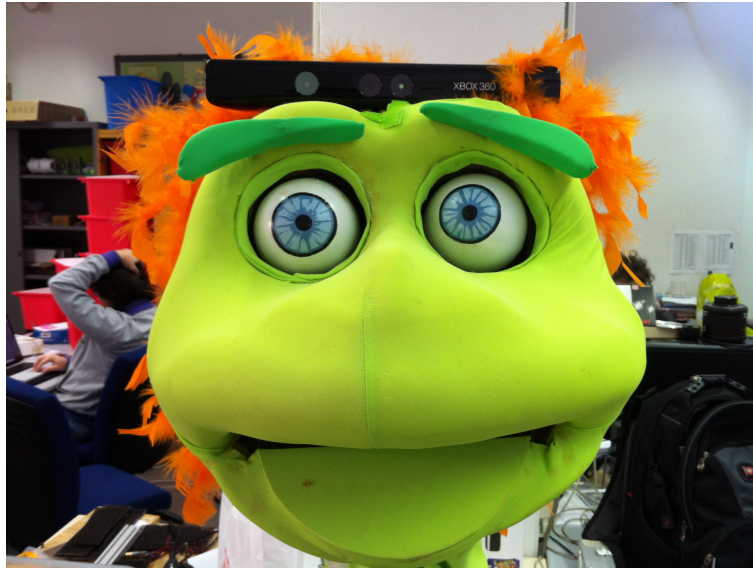
Figura 3.6: Kinect posizionato sopra la testa del robot E-2?.
