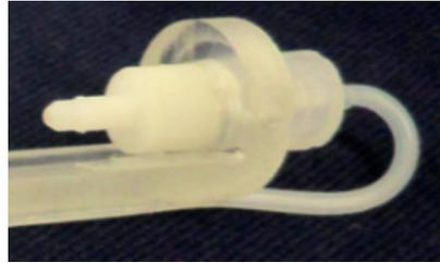
**Figura 3.6** Particolare del portavaso in cui è mostrato il connettore B su cui è avvitato un connettore luer connesso ad un portagomma, entrambi in polipropilene. Su di esso è calzato il tubo in silicone che connette l'uscita del vaso al resto del circuito.
