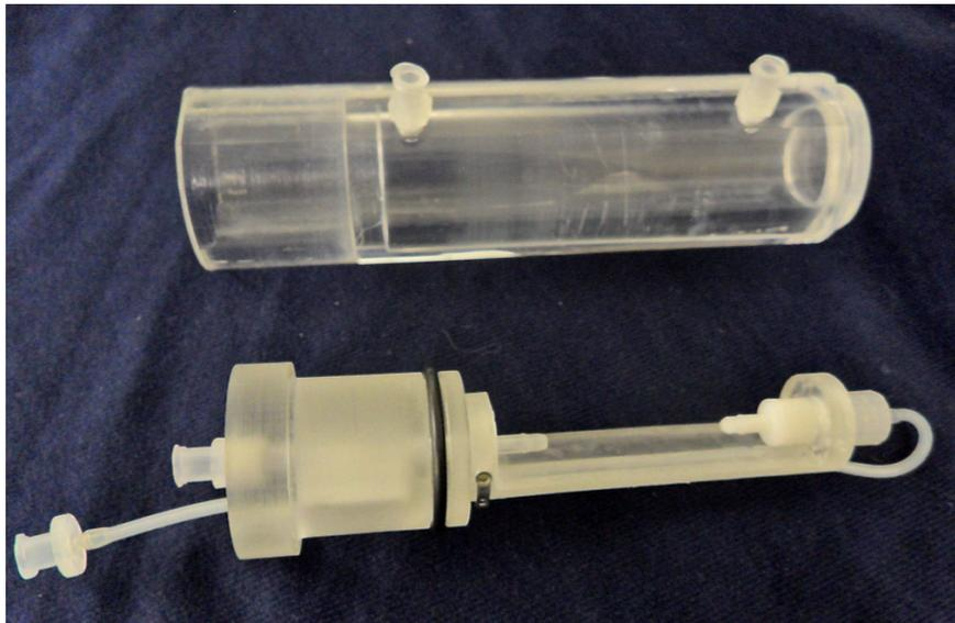
**Figura 3.10** Foto in cui sono mostrati i componenti del prototipo 0. In alto è possibile osservare la riserva con i due connettori luer avvitati. In basso è mostrato l'insieme tappo/telaio portavaso; è possibile individuare il circuito in uscita dal vaso vincolato a passare attraverso la scanalatura ricavata nel telaio portavaso e il foro presente sul tappo.
