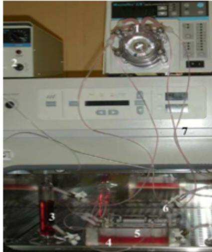
**Figura 2.15** Foto del sistema. 1) Pompa, 2) sensore di pressione, 3) reservoir, 4) camera di perfusione, 5) segmento di vena, 6) flussimetro, 7) tubi in silicone.
