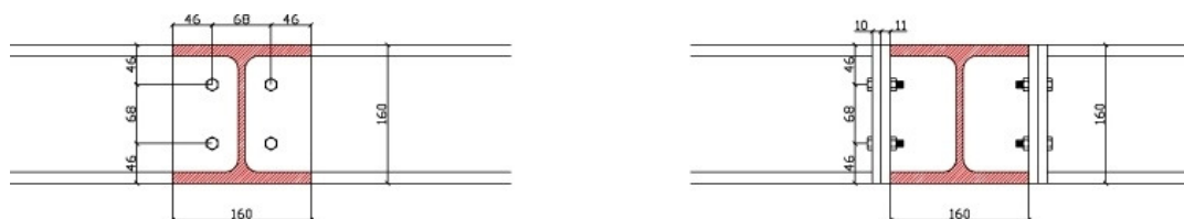
Figura 6.10-2 Unione trave primaria HEB 160 - trave secondaria HEB 160.
