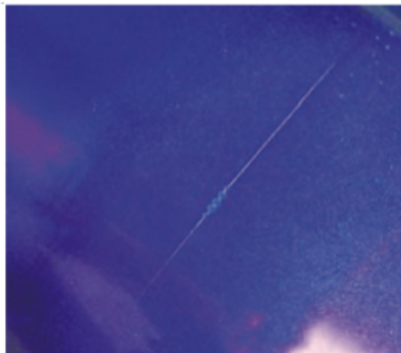
Figura 3-4 Difetto sul corpo cilindrico, evidenziato dal CND utilizzando le particelle magnetiche fluorescenti
