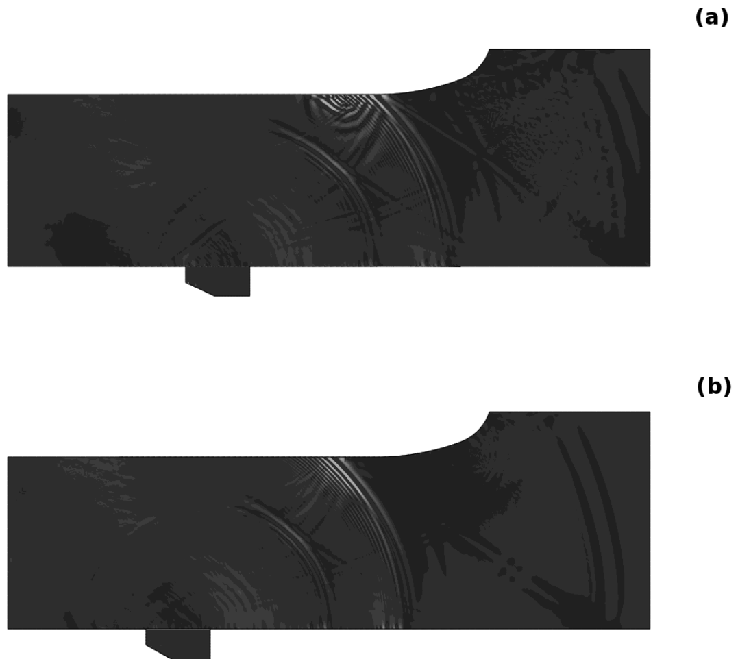
Figura 3-6 Frame simulazioni per il difetto sul corpo cilindrico all'istante 27 \cdot 10^{-6} [s], (a) sonda 38^\circ e (b) sonda 45^\circ
