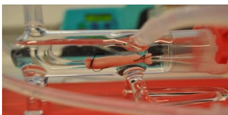
Figura 3: Vascular Package TEB 100 Series con l'esofago ancorato con filo di sutura ai tubi di vetro della camera di perfusione
