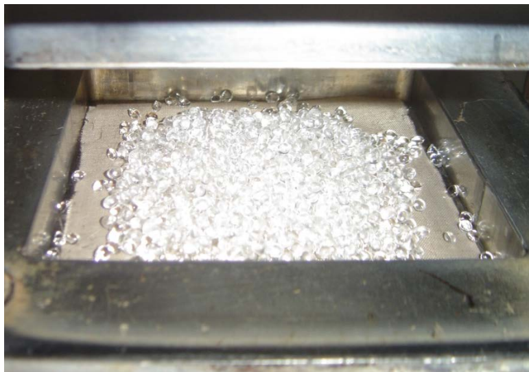
Figura 2.1. Preparazione della fase di stampaggio del materiale.
