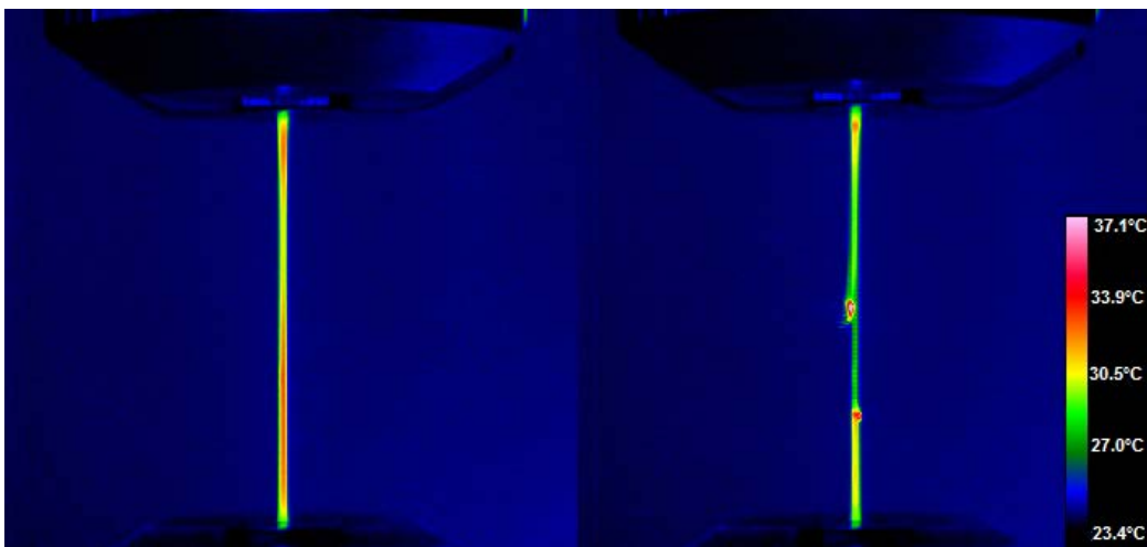
Figura 2.22. Termografia del provino sottoposto a trazione alla velocità di 1mm/s immediatamente prima e dopo la rottura.
