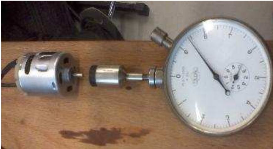
Figura 104 – sensore di velocità analogicoinerziale connesso al motore
