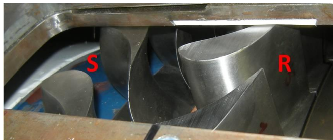
Fig. 6.1 : stadio di turbina montato sulla macchina
