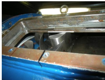
Fig. 1.4 : statore e rotore turbina
