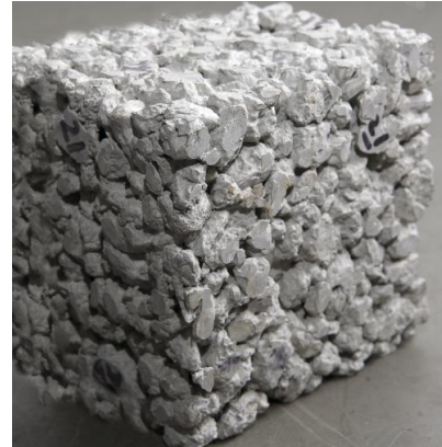
Fig. 2.8 Campione di calcestruzzo poroso no-fines
