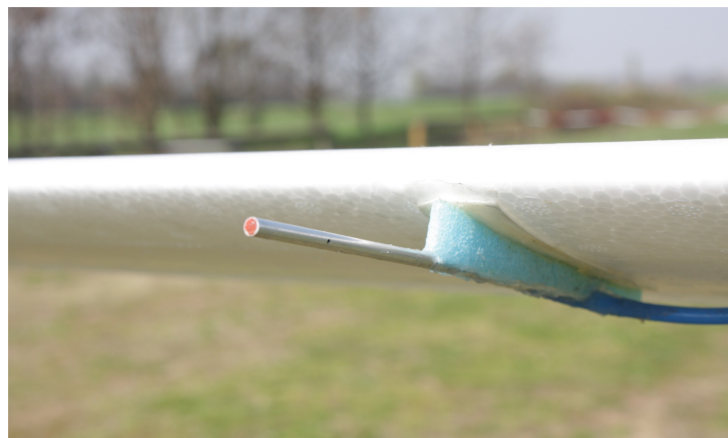
Figura 1.13. Dettaglio dell'installazione della sonda di pressione statica sotto la semiala sinistra.
