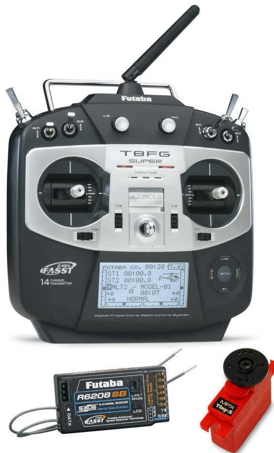
Figura 1.2. Radiocomando Futaba® 8FG Super, con ricevente R6208 SB e servo Multiplex® Tiny S.
