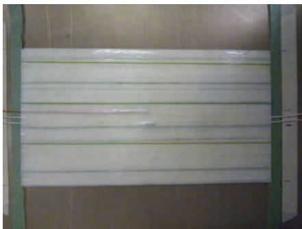
(c) Posizionamento lamina in composito al disopra delle FO
