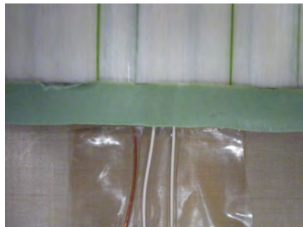
(d) Protezione delle FO mediante plastilina e teflon
