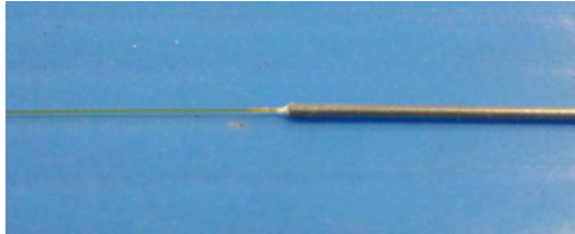
Figura 4.4: Preparazione capillare per la verifica dell'isolamento
