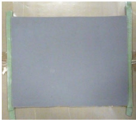
(a) Posizionamento di teflon microforato e gomma
