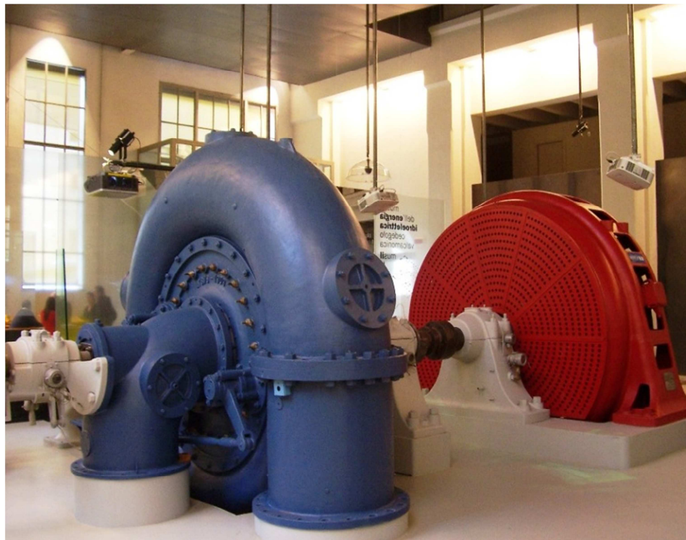
Turbine idroelettriche per la trasformazione di energia cinetica in meccanica
