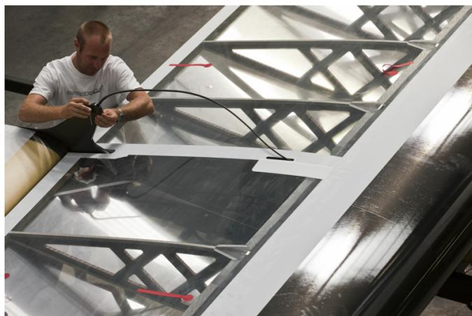
Figura 1.12: Dettaglio sulla struttura interna delle wingsail - *Courtesy of americascupmedia.com*
