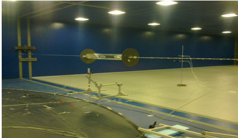
Figura 3.1-1: Cilindro vincolato all'interno della galleria
