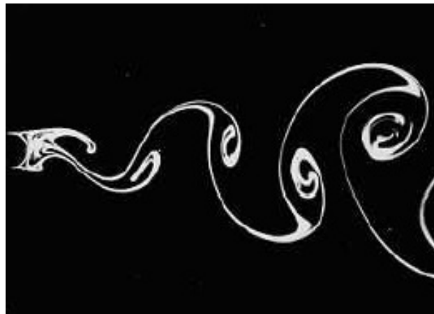
Figura 2.1-4: Distacco di vortici a bassa velocità
