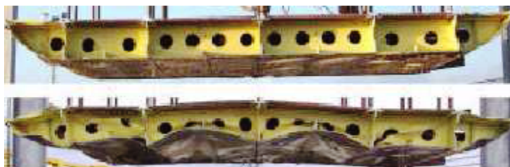
Figure 12: Sotto pavimento prima e dopo l'impatto
