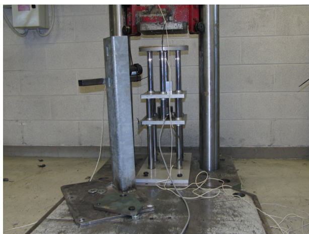
Figure 9: Prova sperimentale per la caratterizzazione dell'assorbitore
