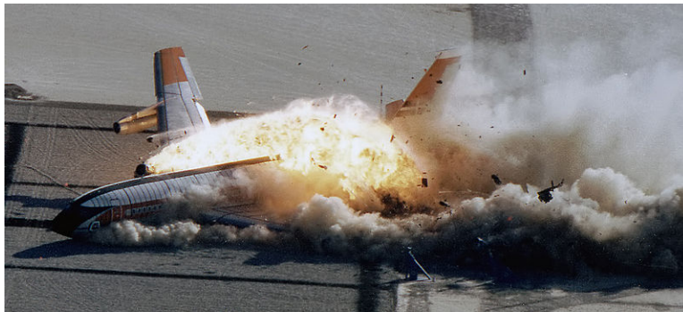
Figura 2: Prova su scala reale dell'aereo da trasporto B720
