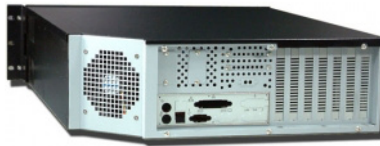
Vista posteriore con il caratteristico angolo tagliato per ospitare la ventola da 90 mm
