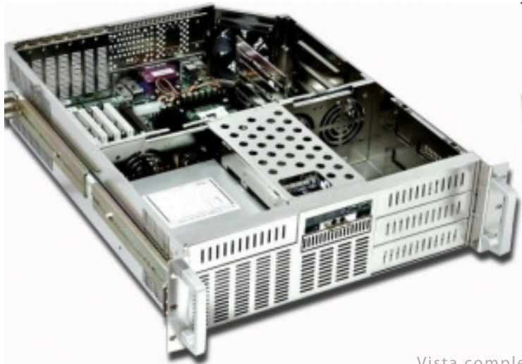
Vista complessiva con mainboard, alimentatore e slide rails. Lo sportello frontale è rimosso.
