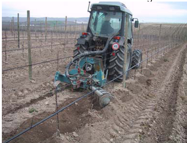
Fig. 6. Lavorazione del terreno con attrezzo interceppo a dischi verticali.
