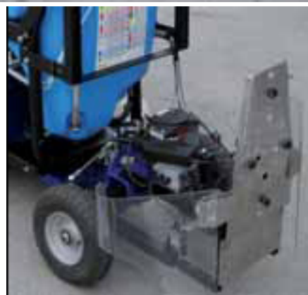
Fig. 6 - Versione aggiornata del sistema proposto con montata anche una barra di distribuzione orizzontale e Particolare del nuovo sistema di tastatori frontali.
