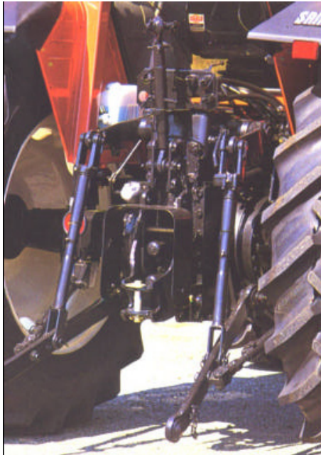
Fig. 2 - Alcuni esempi di ganci di traino agricoli: in alto a sinistra: gancio di categoria A (denominato spesso anche “barra di traino”), regolabile nel solo piano orizzontale; in basso a sinistra: gancio di categoria C, regolabile solo in altezza; in alto a destra: i bracci inferiori dell’attacco a tre punti sono uniti da una barra forata, a realizzare un gancio “atipico”, assimilabile alla barra di traino (dietro la barra forata è visibile un gancio di categoria B). In tutti i casi la parte effettiva di aggancio è un perno.
