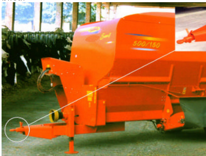
Fig. 1 - I timoni montati sulle macchine operatrici trainate (in questo caso un carro miscelatore) terminano con un occhione, nel quale viene infilato il perno del gancio di traino del trattore.
