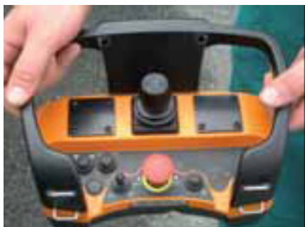
Fig. 1 - Dispositivi per il controllo remoto della sterzata e pannello di comando remoto
