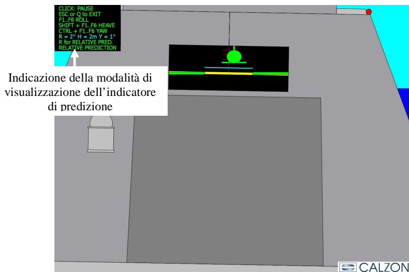
Figura 28 – Indicatore della modalità di visualizzazione della predizione dell'heave
