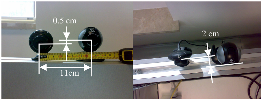
Figura 39 – Parametri reali del sistema di visione stereo
