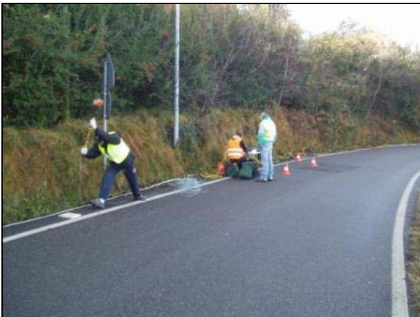
Figura 2.5 Energizzazione stendimento a 3 metri.
