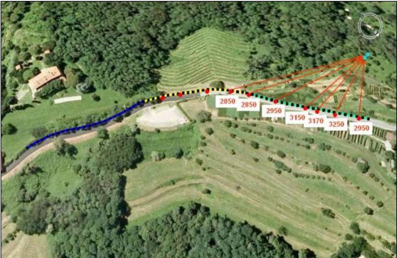
Figura 1.8: Velocità media degli strati sottostanti al primo (in m/s), ricavata dai tempi di volo delle misure in trasparenza depurati del tempo di attraversamento del primo strato, ottenuti sulla base dei risultati della sismica a rifrazione.
