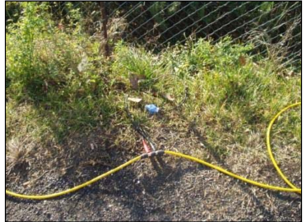
Figura 2.4 Geofono con punzone.
