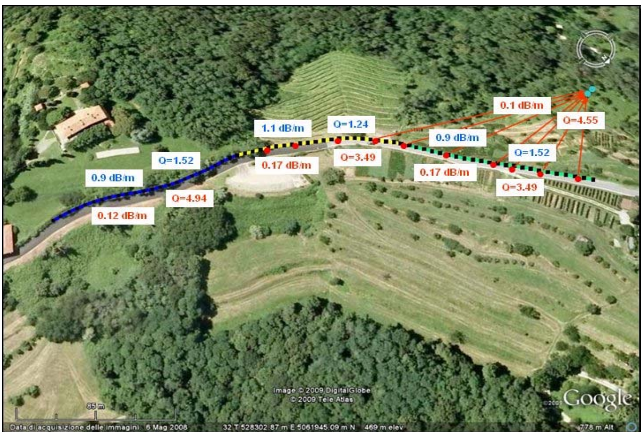
Figura 1.9: Valori medi di attenuazione e fattore di qualità ottenuti dai dati a rifrazione ed in trasparenza del primo e del secondo strato (rispettivamente in blu e rosso).
