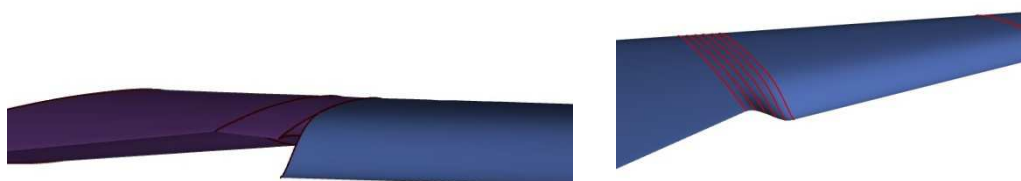
FIGURA 10.27 – CONFRONTO TRA LE GEOMETRIE DELL'ALETTONE CLASSICO DISCONTINUO E QUELLO MORPHING RACCORDATO
