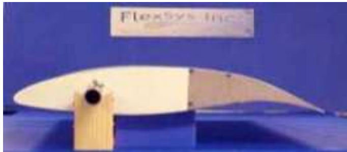
FIGURA 1.18 – MODELLO DI PROFILO MACW DEL PROGRAMMA FLEXSYS INC. PER LA DEFORMAZIONE DEL BORDO D’USCITA
