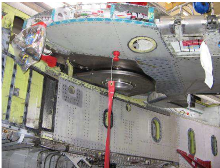
FIGURA 1.4 – DETTAGLIO DEL MECCANISMO ALARE PER LA VARIAZIONE DELLA FRECCIA DURANTE UNA ISPEZIONE
