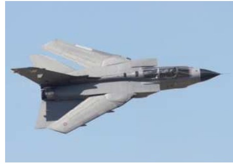
FIGURA 1.5 – PANAVIA TORNADO: A SINISTRA CON ALI AL MINIMO ANGOLO DI FRECCIA; A DESTRA CON ALI RACCOLTE AL MASSIMO ANGOLO DI FRECCIA
