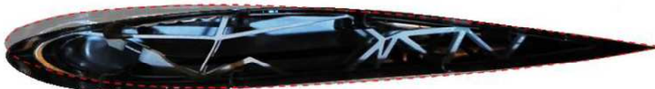
FIGURA 1.20 – SPACCATO DI UN PROFILO ALARE CON MECCANISMI COMPLIANT DI MORPHING
