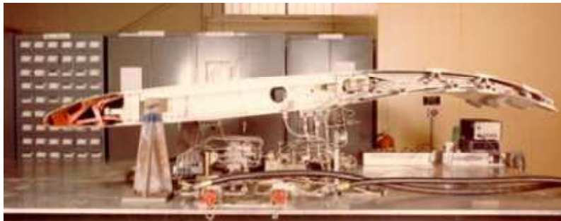
FIGURA 1.15 – STRUTTURA A TRAVI INTERNA AD UNA DELLE SEZIONI ALARI DEL F-111; POSIZIONE DEFORMATA AL BORDO D’USCITA
