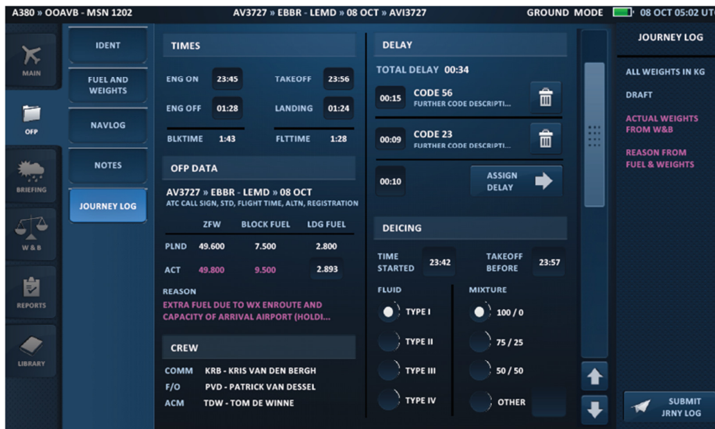
Figura 19: Interfaccia del Software sviluppato per la stima delle emissioni utilizzando l'EFB
