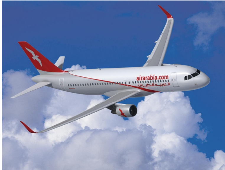
Figura 12: AirArabia A320 equipaggiato con sharklet
