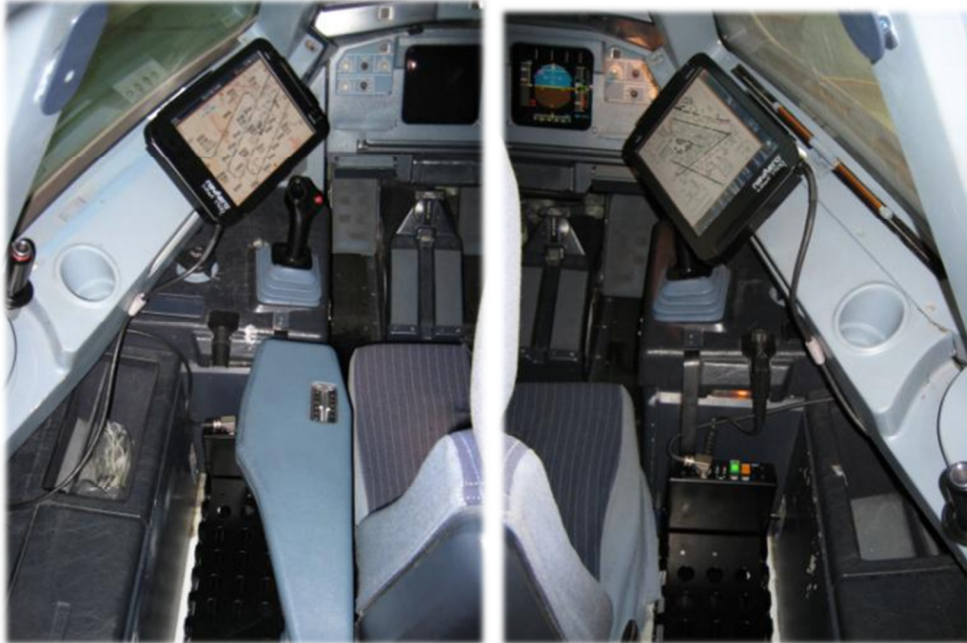
Figura 83: Hardware EFB Classe II installato nel primo Aeromobile AirArabia
