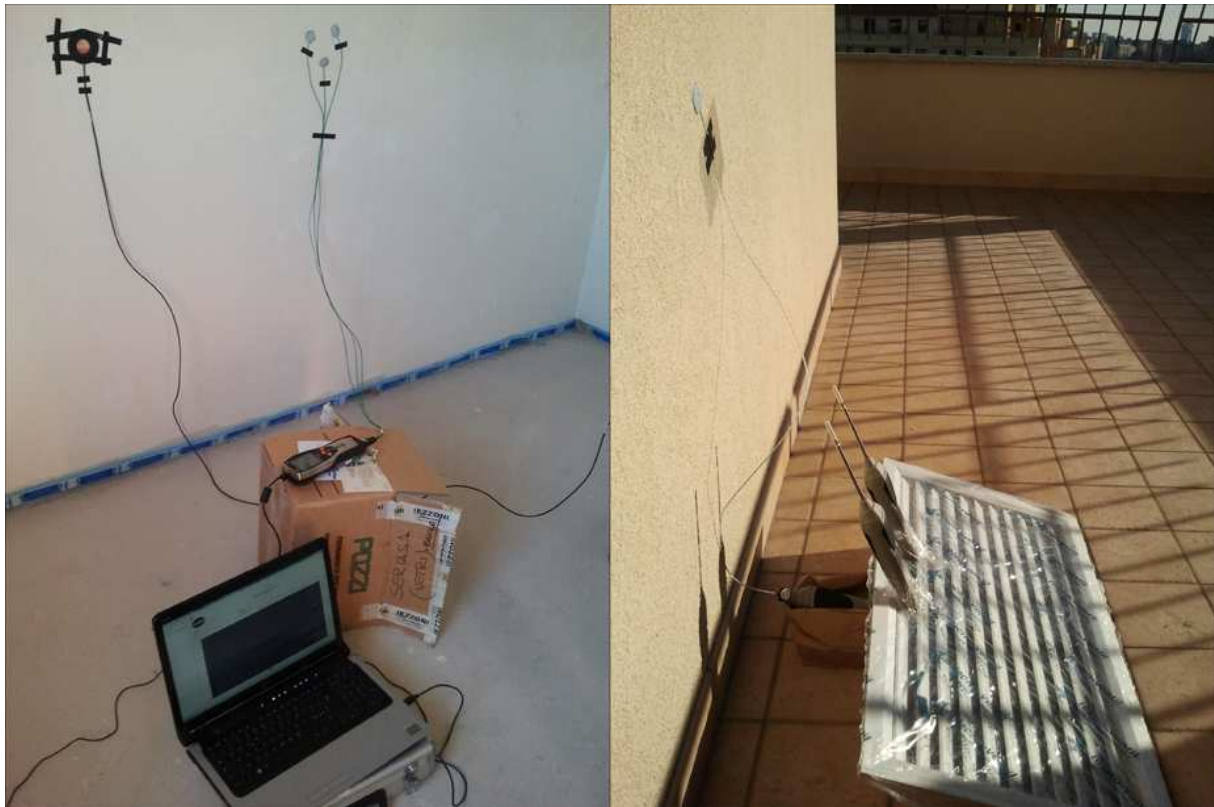
Fig. 06 – Posizionamento delle sonde termoflussimetriche interne ed esterne
