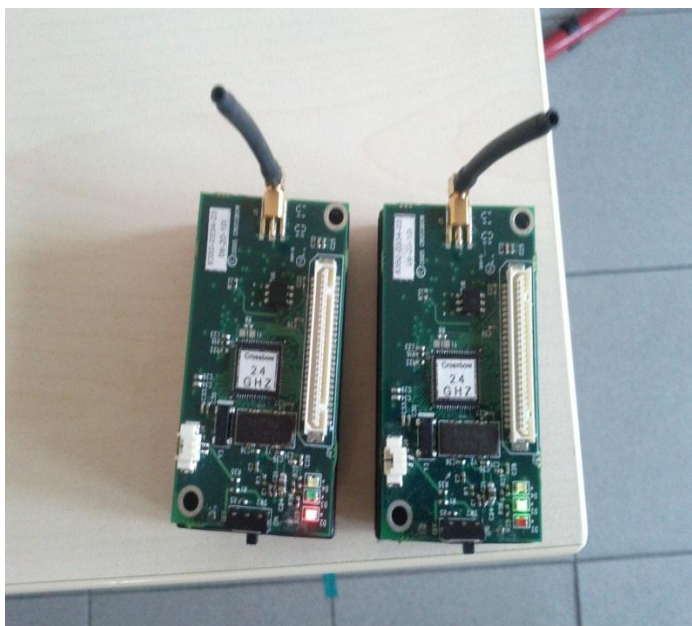
Figura 5.3 : Handover del nodo mobile con 1 e in seguito con 2
