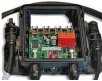
Figura 24. Esempio di elettronica integrata nella JB
