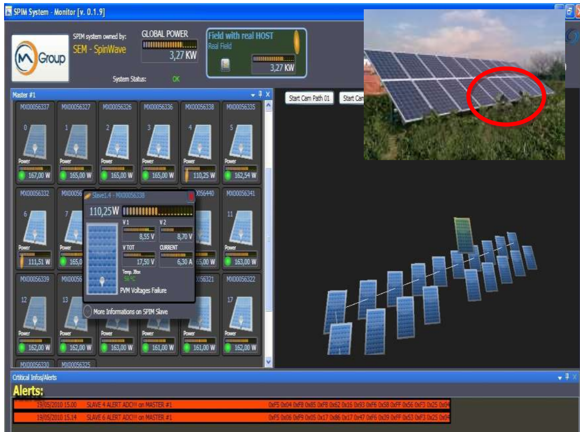
Figura 25. Esempio di individuazione di un pannello oscurato
