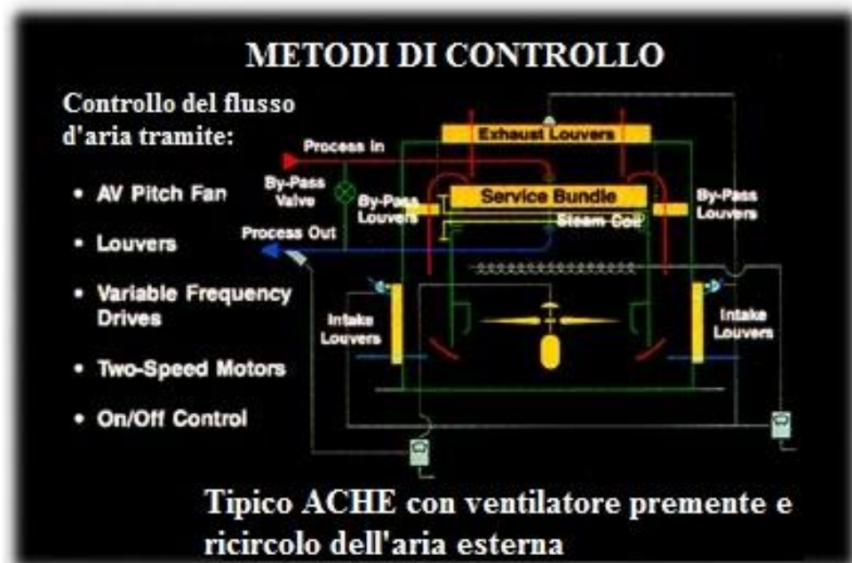
Figura 4.7: . Metodi per il controllo del processo. Fonte: Hudson products.
