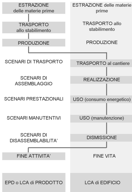
Figura 5.5: Integrazione tra le fasi caratterizzanti la scala del prodotto edilizio e la scala dell'edificio; Fonte: M. Lavagna, 2008;
