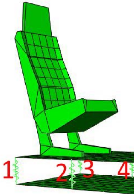
Figura 38- Assorbitori coinvolti nel calcolo della corsa del sottopavimento
