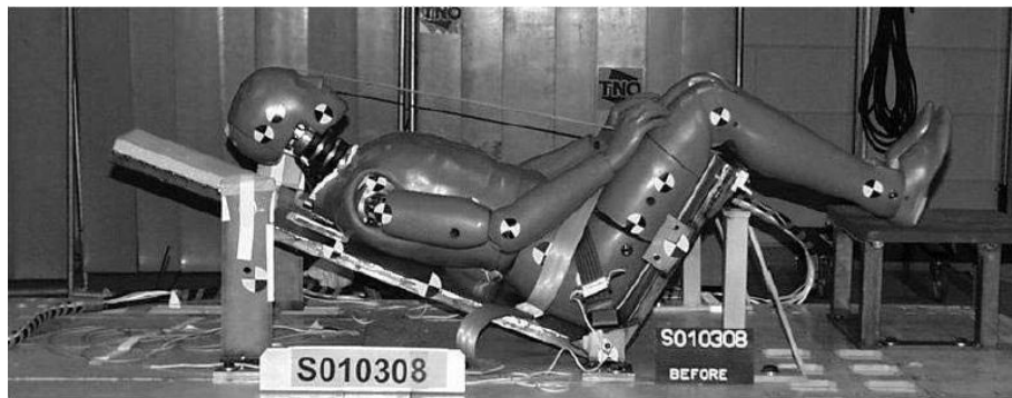
Figura 21 – Prova sperimentale sul manichino Hybrid III 50° percentile disposto su sedile rigido con sistema di ritenzione a due punti di ancoraggio
