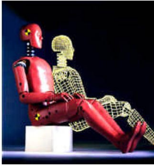
Figura 10 – Manichino antropomorfo Hybrid III – Cinquantesimo percentile
