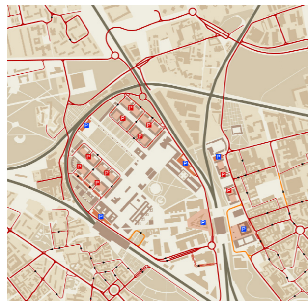
fig. 33: schema della viabilità. Le linee sottili rappresentano zone 30 vietate ai mezzi pesanti, le linee arancioni rappresentano le zone a traffico limitato. I parcheggi pubblici sono contrassegnati da simbolo blu mentre quelli privati da simbolo rosso.
