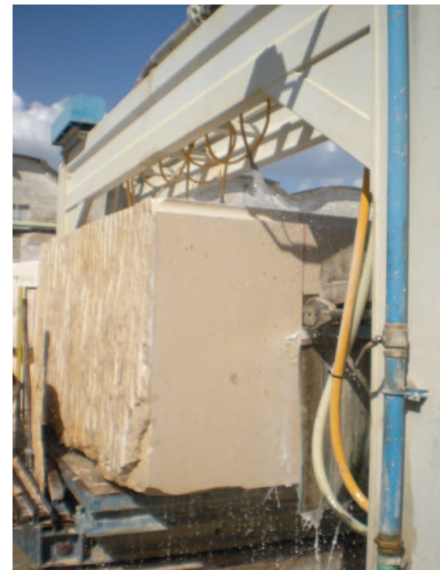
Fig. 1.19_ Taglio del blocco con il telaio monolama a Vila Viçosa
