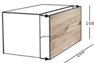
4 pannelli sono avviti alla struttura: il muro si apre
