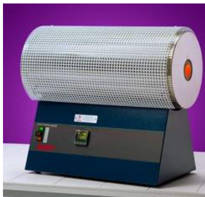
Figura 3.7: Forno tubolare della Lenton Presente nei laboratori.
