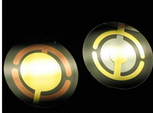
Figura 3.4: Cristallo piezoelettrico contattato in oro per microbilancia.
