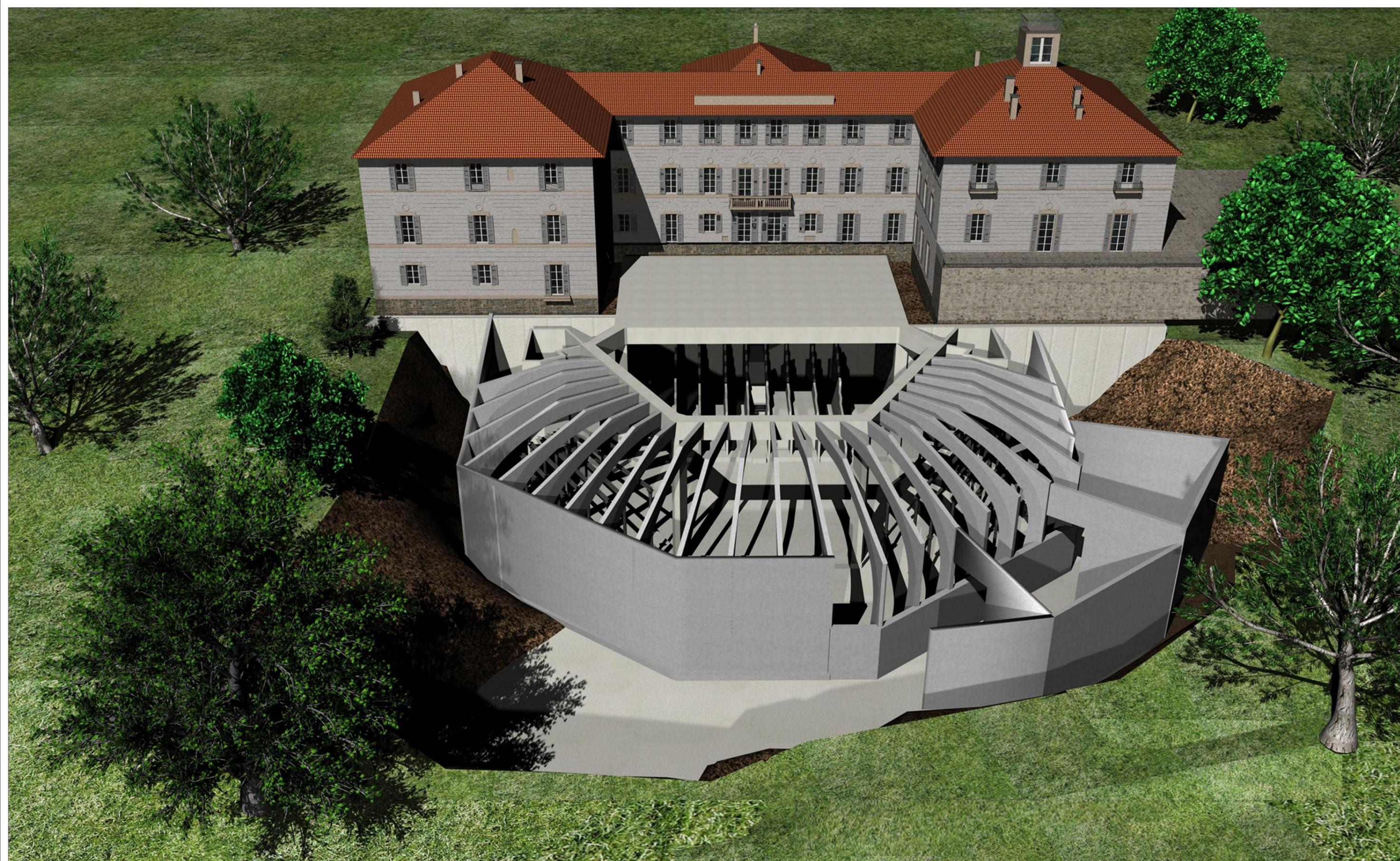
FASE 14: Getto dei muri inclinati (al cui interno viene inserito polistirolo ad alta densità), delle due scatole in c.a. delle scale di emergenza, delle centine e della trave da 130 cm che poggia sui pilastri (la trave è predisposta con connettori meccanici Lenton per ripresa ferri del cassettonato, la faccia interna della trave va scarificata con martello pneumatico per aumentare ingranamento con il successivo getto del cassettonato).
